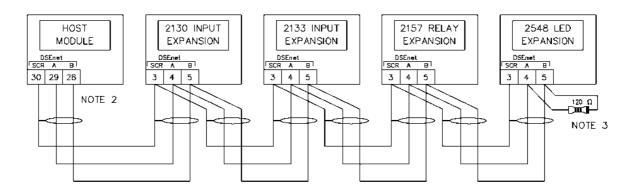
NOTE 2 AS A TERMINATING RESISTOR IS INTERNALLY FITTED TO THE HDST CONTROLLER, THE HDST CONTROLLER MUST BE THE FIRST UNIT ON THE DSEnet NOTE 3 A 120 DHM TERMINATION RESISTOR MUST BE FITTED TO THE LAST UNIT ON THE DSEnet
